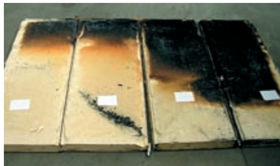
Minimální přispění materiálu jádra k požárnímu zatížení. Uvnitř panelu mezi povrchovými vrstvami nedochází k šíření plamene.
