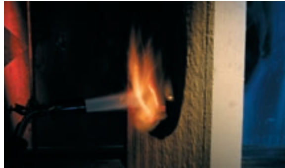
Zkouška propanovým hořákem demonstruje, že se jádro nevznítí a odkryté nepředstavuje hrozbu požáru.
