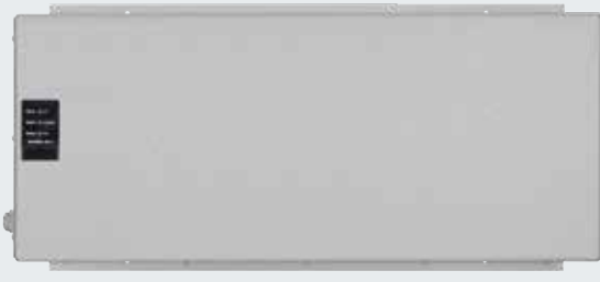
Nepřerušitelný napájecí zdroj USV k překlenutí výpadků napětí do 4 hodin, bezpečnostní zařízení, signální světla atd. zůstávají v provozu, indikace stavu pomocí LED, automatický test baterie, přepětový filtr, Rozměry: 560 x 235 x 260 mm (š x v x h), Stupeň krytí: IP 20
